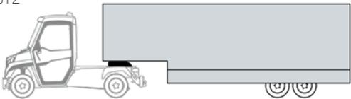
Version für das Ziehen eines Sattelauflegers mit Anlaufscheibe mit PIN 2"
